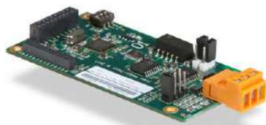
Tarjeta de salida analógica 0-10 VCC y 4-20 mA.
