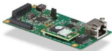
Tarjeta interna inalámbrica Inalámbrica 802.11b/g
